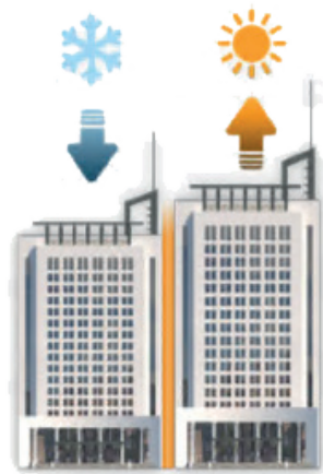
Dilatation et contraction des structures
